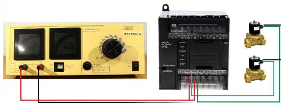
Gambar 3. 6 Skematik rangkaian sistem kontrol PLC
