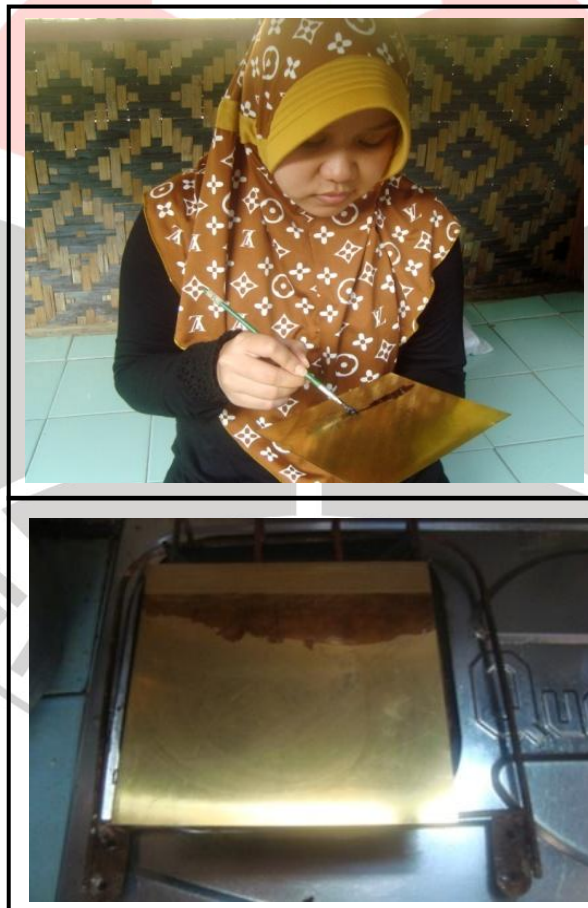
Gambar 3.21 Proses Melapisi Plat dengan Aspal dan Pemanasan Plat (Sumber: Dokumentasi Pribadi)
