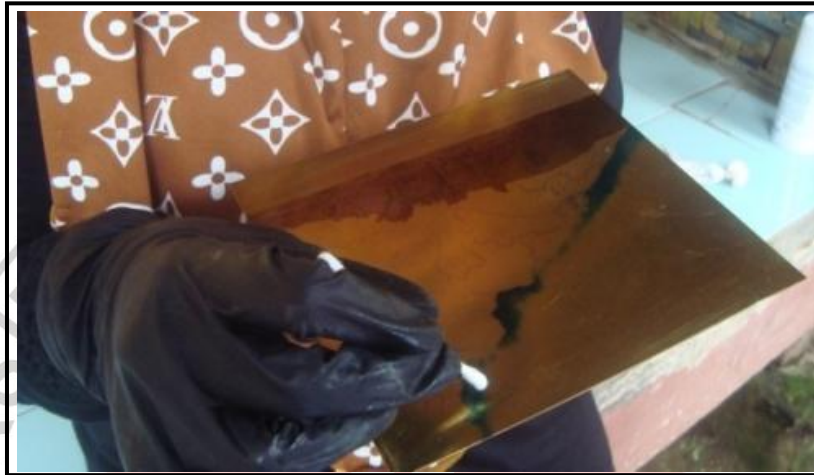
Gambar 3.22 Menutupi Bagian Plat dengan Tinta Cetak (Sumber: Dokumentasi Pribadi)
