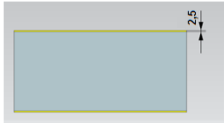
Gambar 3.7 Frais muka bidang 1 dan 2 dari 35 mm menjadi 30 mm
