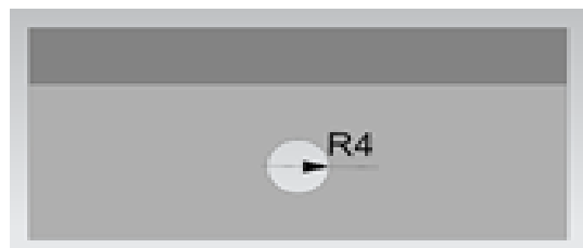
Gambar 3.10 Drilling dengan matabor \varnothing 8 mm dari bidang 1 hingga menembus bidang 2
