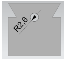
Gambar 3.9 Drilling dengan matabor \phi 5,2 \text{ mm} dari bidang 3 hingga menembus bidang 4
