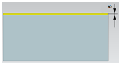
Gambar 3.6 Frais muka bidang 5 dari 35 mm menjadi 30 mm
