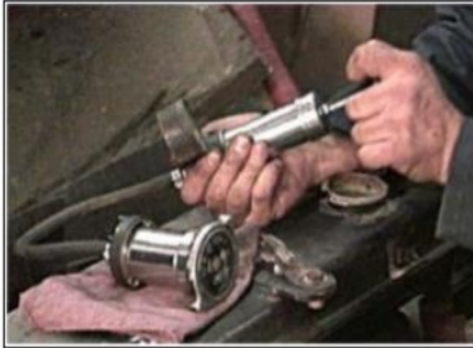
Gambar 3.3 Pengujian Cap Radiator (sumber : Perawatan Cooling System Pada Engine 3054C dari Perawatan Engine Dan Unit Alat Berat, 2013)
