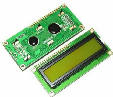
Gambar 3.9 Tampak Depan dan Tampak Belakang LCD 1602 (Sumber : www.tokopedia.com )
