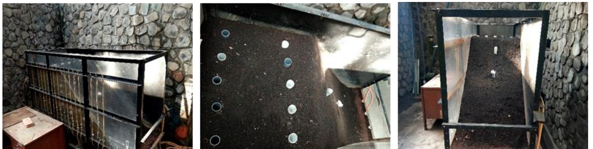
Gambar 3. 1. Lereng buatan pada bak uji yang terdapat di laboratorium geoteknologi lembaga ilmu pengetahuan Indonesia.
