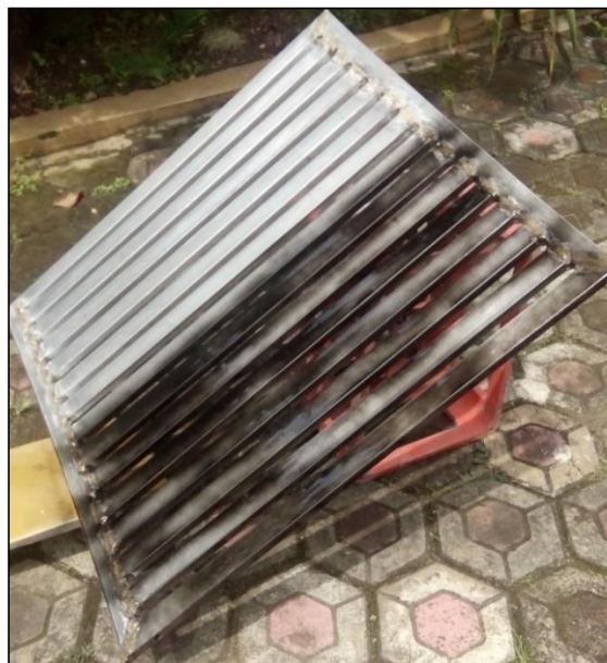
Gambar 3 5 Proses Pengacatan Panel Pemanas Air
