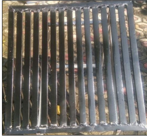
Gambar 3 6 Hasil Pengecatan pada Panel Pemanas Air
