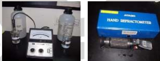
Gambar 3.3 Alat Pengukur Salinitas/Refraktometer (kanan); Alat-bahan Pengukur pH Meter (kiri)
