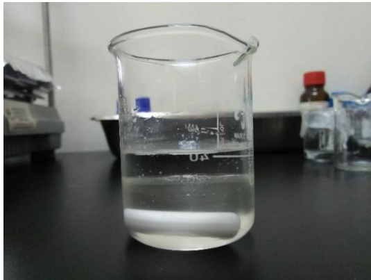
Gambar 3.4 Dua fasa yang terbentuk setelah Purifikasi
