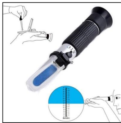
Gambar 3.9 Alat ukur indeks bias
