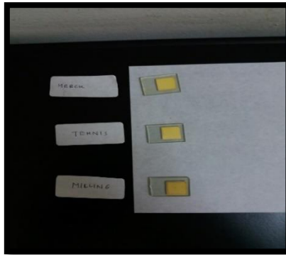
Gambar 3.6 Hasil Perendaman Dye Kunyit Pada \text{TiO}_2
