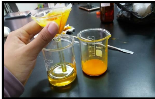
Gambar 3.4 Proses Penyaringan Dye
