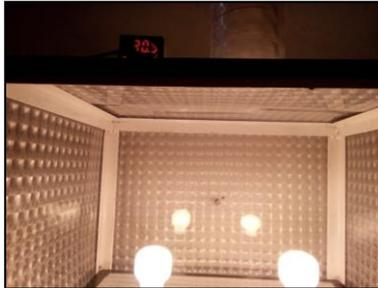
Gambar 3. 13 Pengujian respon rangkaian sensor RTD PT00 dengan Autonics TK4S-14RN
