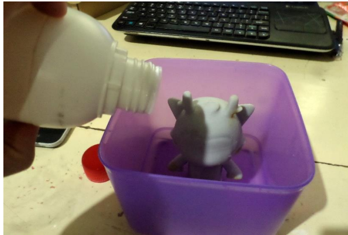
Gambar 3.27. Pembuatan Cetakan ( Molding ) (Sumber: Dokumentasi Penulis, 2018)
