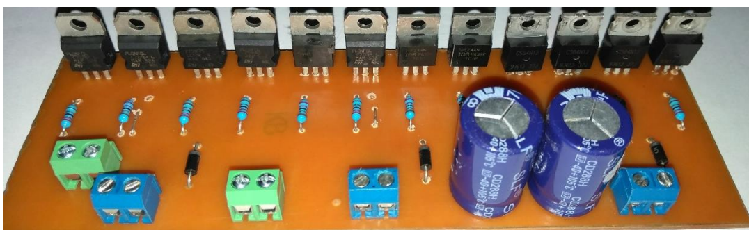
Gambar 3. 14 gambar layout PCB driver mosfet dan inverter setelah dipasang komponen
