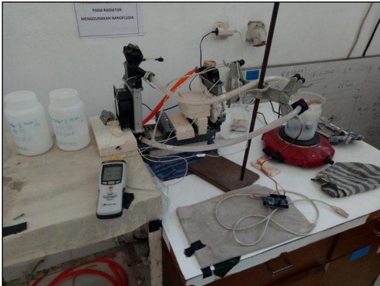
Gambar 3.12 Set Eksperimen Heat Transfer pada Radiator
