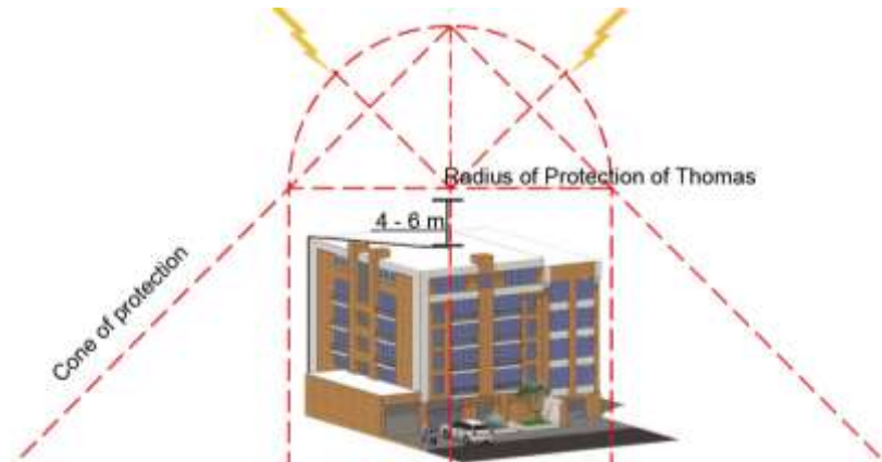
Gambar 3. 26 Penangkal petir Sumber: sistem struktur bangunan tinggi
