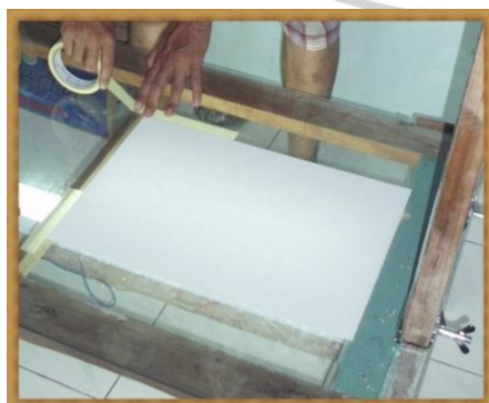
Gambar 3.40 Memasang Kertas pada Meja Sablon (Sumber Dokumentasi Pribadi)
