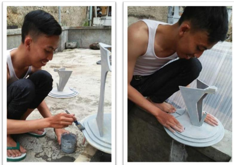
Gambar 3.59 Pengecatan Cat *pyroxylin lacquer* dan Pengamplasan *Base*
