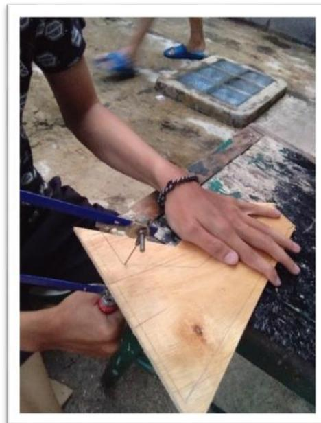
Gambar 3.57 Pemotongan Kayu Multiplek
