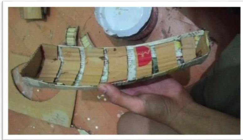
Gambar 3.49 Hasil Lapisan Kertas yang Sudah Dibuka dari Cetakan
