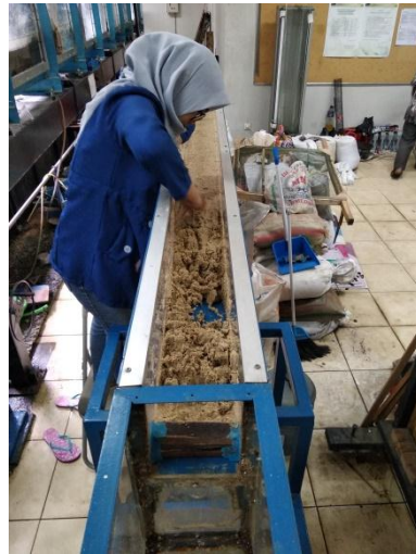
Gambar 3. 11 Proses Penghamparan dan Perataan Pasir (Sumber : Dokumentasi Pribadi)
