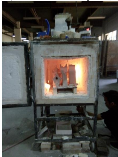
Gambar 3.23 Proses penyalan api
