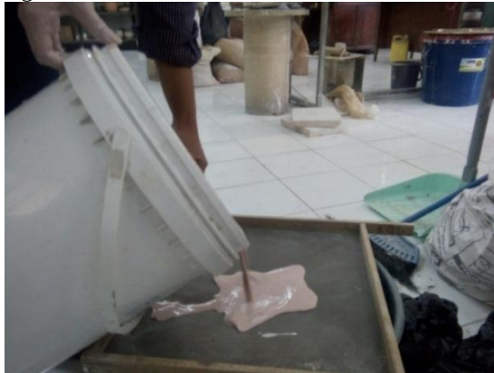
Gambar 3.21 Proses penyaringan bahan glatsir (Sumber : Dokumentasi pribadi )
