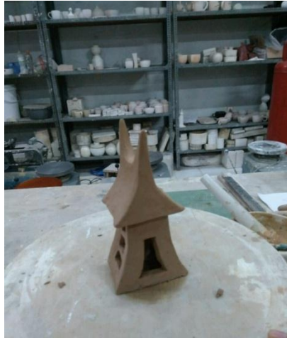
Gambar 3.16 Proses pengeringan (Sumber : Dokumentasi pribadi)
