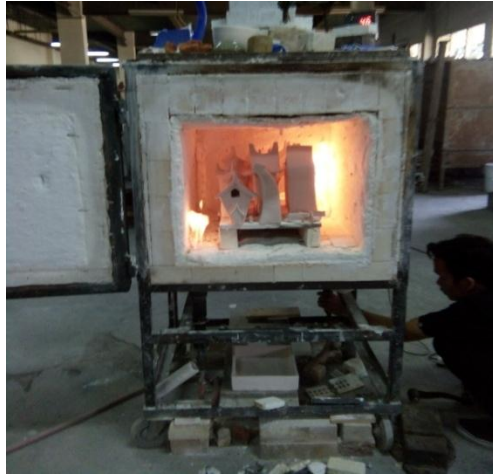
Gambar 3.18 Penguapan ( water smoking ) pembakaran biskuit (Sumber : Dokumentasi pribadi)
