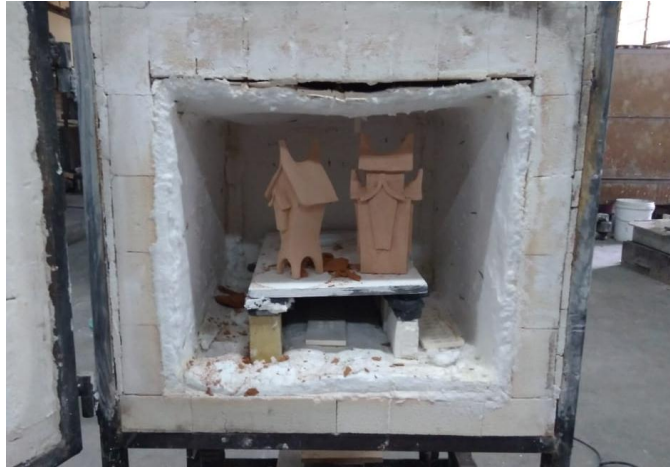
Gambar 3.17 Memasukan keramik kedalam tunggu (Sumber : Dokumentasi pribadi)
