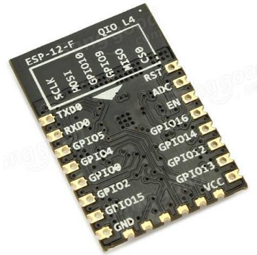
Gambar 2. 6 Datasheet ESP8266 12-F sebagai Modul Wifi
