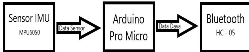
Gambar 3.3 Diagram Balok Perancangan Hardware Alat Ukur Power Tendangan dan Pukulan
