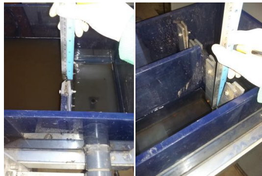
Gambar 3.10 Pengukuran Tinggi V-notch
