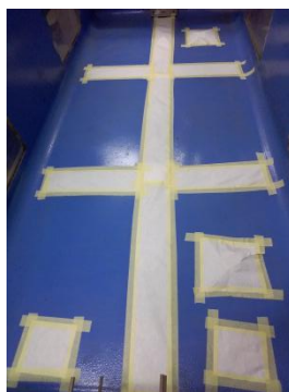
Gambar 3.6 Pemasangan Kertas Filter pada Alat Rainfall Simulator
