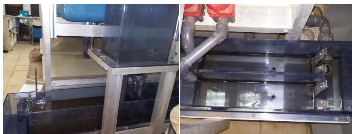
Gambar 3.3 V-notch pada Alat Rainfall Simulator
