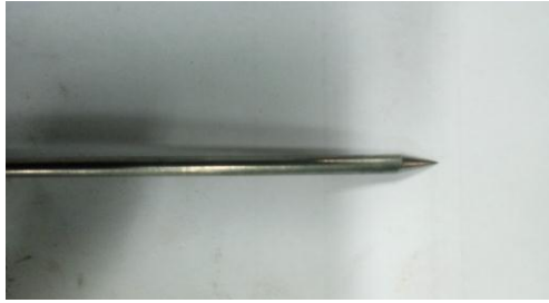
Gambar 3.26 Sudut elektroda tungsten setelah melakukan uji coba alat
