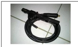
**Gambar 2.22** Pemegang elektroda dan penjepit massa
