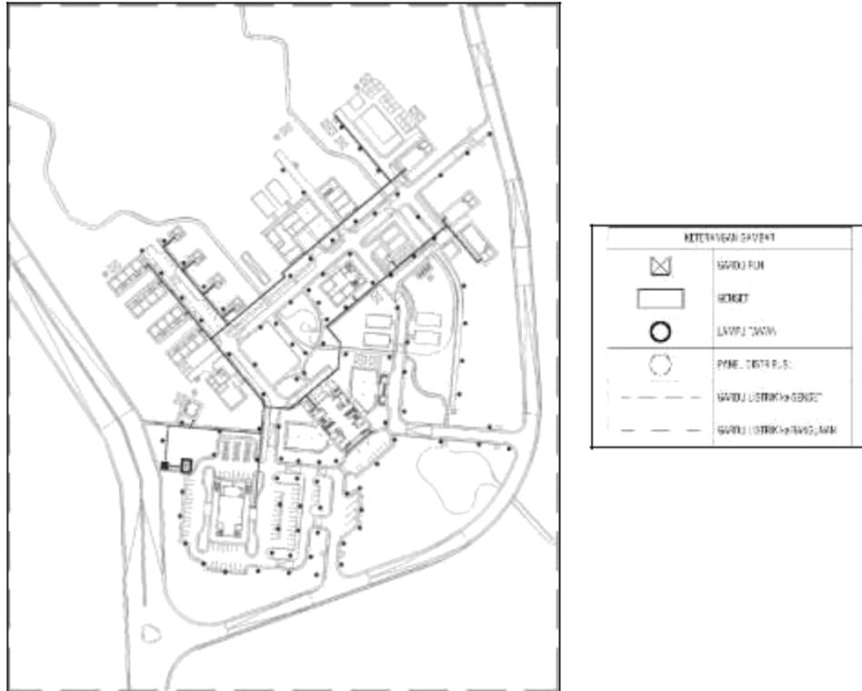
Gambar 5. 21 Konsep Utilitas Jaringan Listrik Kawasan Sumber : Dokumentasi Pribadi, 2018
