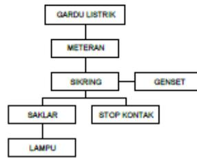
Diagram 5.3 Skema Sistem Elektrikal
