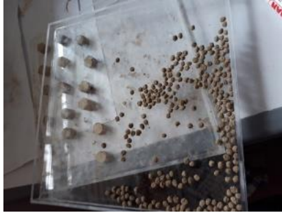
Gambar 3.3 komposisi dari lempung yang ditambahkan kalsit, dan ditambahkan lem dibuat 15 butir kecil dan 3 butir pelet
