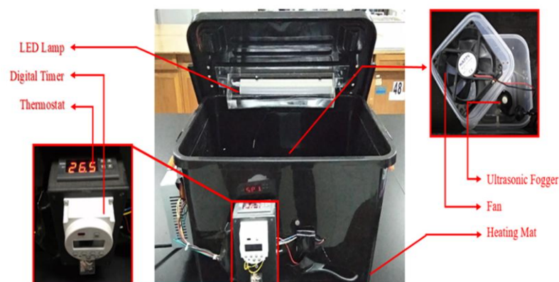
Gambar 3. 2 Skema Alat Germinator
