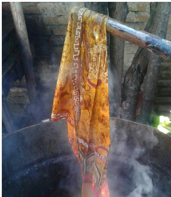
Gambar 3.33 Proses Pelorodan (Sumber : Dokumentasi Pribadi, 2019)
