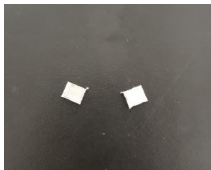
Gambar 3.3 Spesimen Baja Karbon uji SEM
