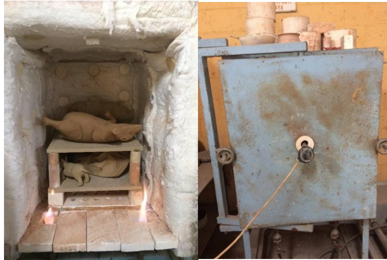
Gambar 4.12 Proses pembakaran bisquit benda keramik (Sumber : Dokumentasi Pribadi, 2019)
