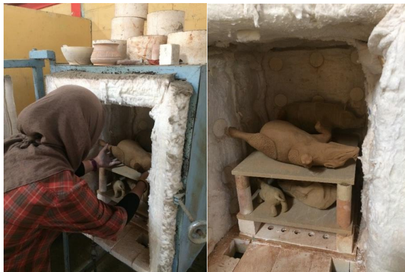
Gambar 4.11 Proses penyusunan ke dalam tungku gas (Sumber : Dokumentasi Pribadi, 2019)
