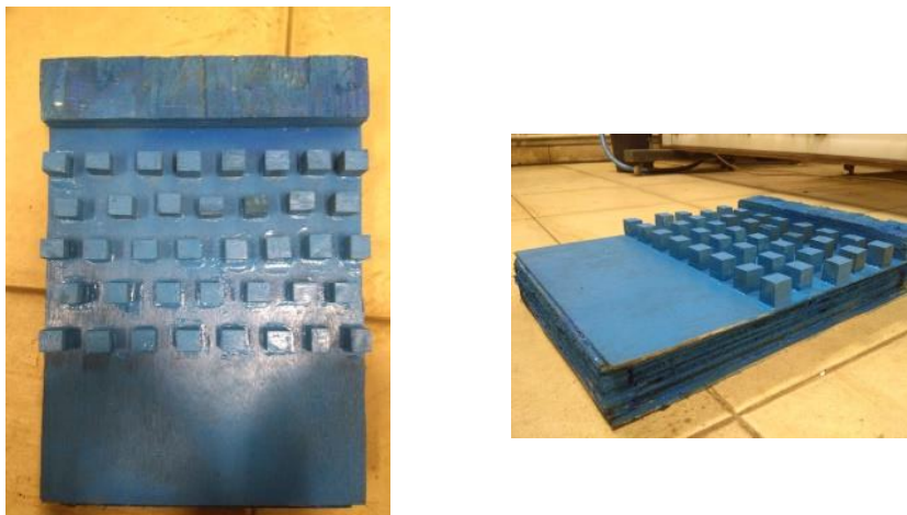
Gambar 3.13 Peredam energi Buffle Block tipe Kotak (Dokumentasi Pribadi)
