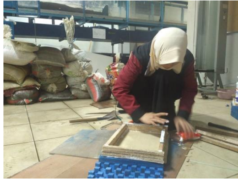
Gambar 3.20 pembuatan peredam energi Buffle Block (Dokumentasi Pribadi)
