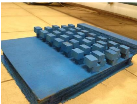
Gambar 3.19 peredam energi Baffle Block (Dokumentasi Pribadi)
