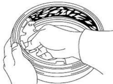
Gambar 3.9 Memeriksa Kesempurnaan Tromol (Sumber: Repair Manual Toyota Fortuner 2011)
