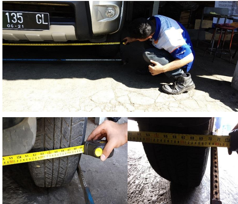
Gambar 3.0.3 Pengukuran Toe In dan Toe out (Sumber Dokumentasi Pribadi)
