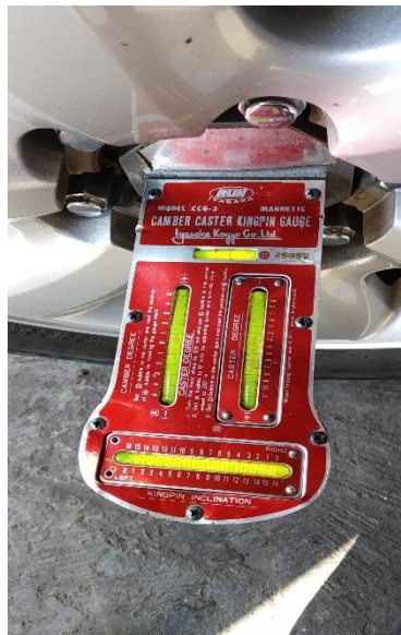
Gambar 3.0.1 Spesifikasi Camber Caster
