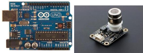
**Gambar 3. 4** Sensor Gas CO<sub>2</sub> MG-811 dan Arduino ATmega328
