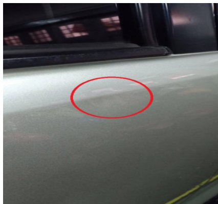
Gambar 3.02 Penyok Pada Pintu Kanan
