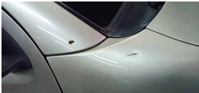
Gambar 3.01 Kerusakan Pada Pilar A dan Fender
