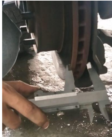
Gambar 3.8 Mengukur Ketebalan Disc
