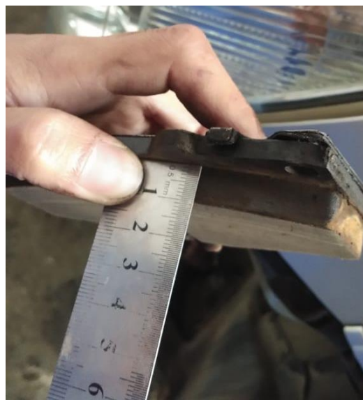
Gambar 3.7 Mengukur Ketebalan Pad
