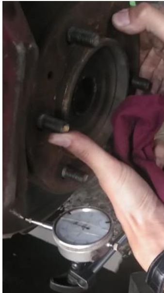
Gambar 3.9 Mengukur Runout Disc
