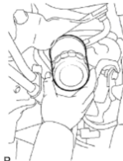
Gambar 3.17 Pemasangan Filter Oli (Toyota: 2011)
