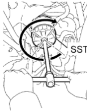
Gambar 3.18 Pengencangan Filter Oli (Toyota: 2011)
