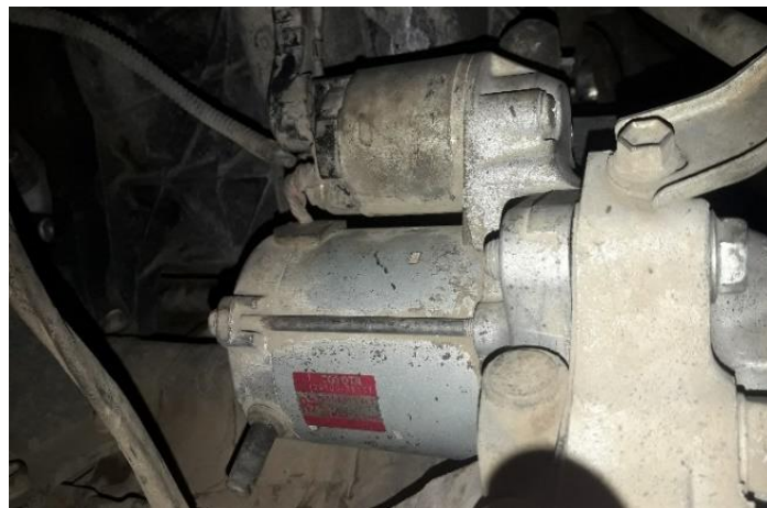
Gambar 3.2 Motor starter menempel pada block engine (Sumber : Dokumentasi)
