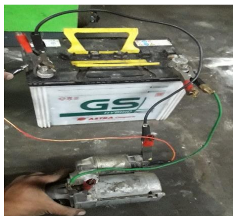
Gambar 3.7 Rangkaian kabel pengetesan kerja tanpa beban (Sumber : Dokumentasi)
