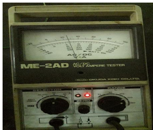
Gambar 3.9 Hasil Pengukuran arus, kerja tanpa beban (Sumber : Dokumentasi)
