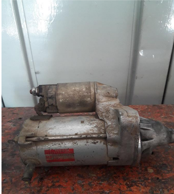
Gambar 3.1 Konstruksi motor starter planetary engine tipe 2TR FE (Sumber : Dokumentasi)
