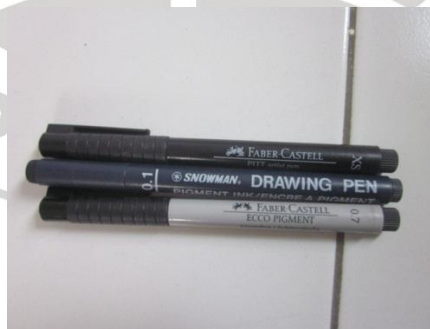
Gambar 3.20 Alat gambar Faber Castell Pitt Artist Pen SX (atas), Drawing Pen Snowman 0.1 (tengah) dan Faber Castell Ecco Pigment 0.7 ( Bawah ) ( Sumber : dokumentasi penulis )
