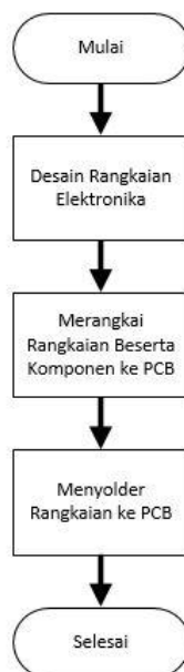
Gambar 3. 2 Diagram Alir Pembuatan Alat Monitoring Daya Listrik
