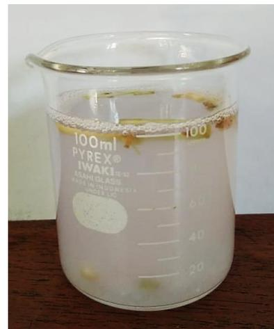
Gambar 3.5 Pencucian Eksplan menggunakan larutan detergen 2%
