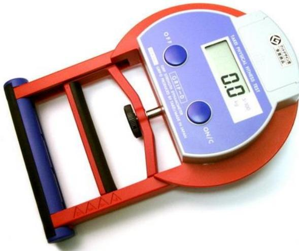
Gambar 3.1 Gambar *Handgrip dynamometer* (Mengukur kekuatan otot tangan).
