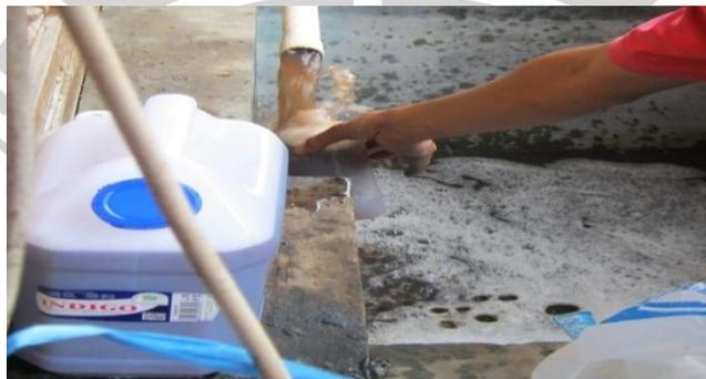
**Gambar 3.5** Pengambilan Sampel Limbah Tekstil Batik pada Saluran Pembuangan Limbah di Daerah Dago
