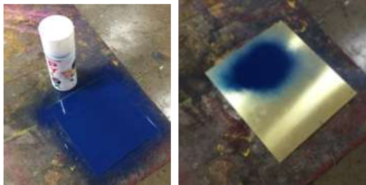
Gambar 3. 26 Pelapisan Plat Menggunakan Cat Semprot (Sumber: Dokumentasi pribadi)
