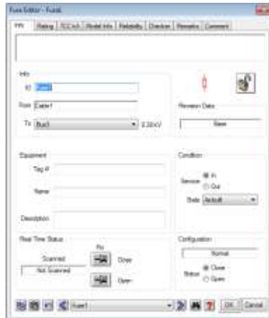
Gambar 3.7 Jendela ETAP untuk Parameter Fuse Cable
