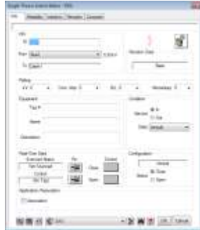
Gambar 3.6 Jendela ETAP untuk Parameter Switch
