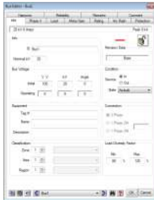
Gambar 3.4 Jendela ETAP untuk Parameter Bus
