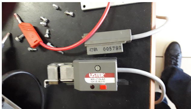
Gambar 3.5 (a) Measuring Head USTER yang memiliki sensor kapasitif yarn clearing
