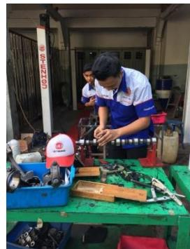
**Gambar 3.5 Pengukuran Poros Kam Menggunakan Mikrometer**
