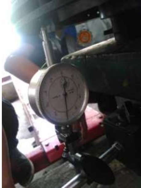
Gambar 3.7 Pemeriksaan kondisi permukaan cakram (Sumber : Dokumentasi pribadi)
