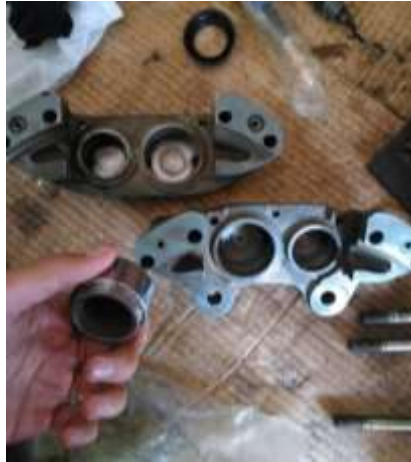
Gambar 3.9 Kondisi piston rem cakram (Sumber : Dokumentasi pribadi)
