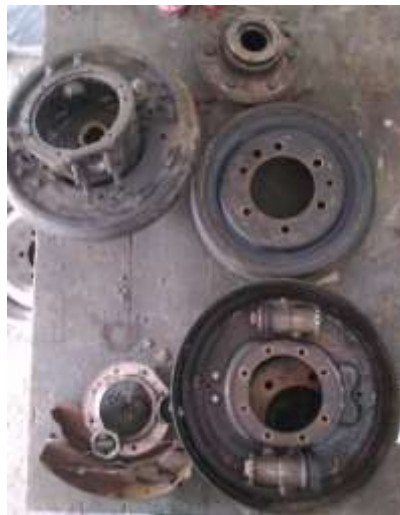
Gambar 3.2 Kondisi rem tromol setelah di bongkar (Sumber : Dokumentasi pribadi)
