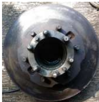
Gambar 3.6 Kondisi rem cakram setelah dibersihkan (Sumber : Dokumentasi pribadi)
