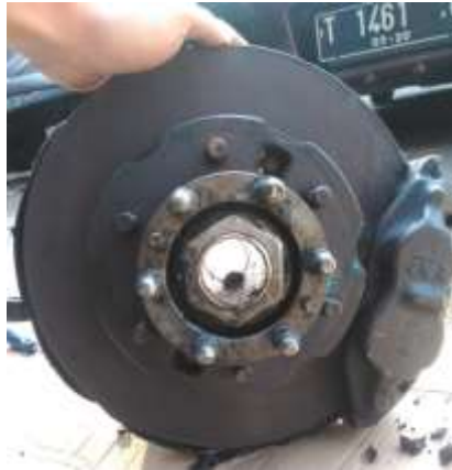
Gambar 3.5 Kondisi rem cakram sebelum dibersihkan (Sumber : Dokumentasi pribadi)
