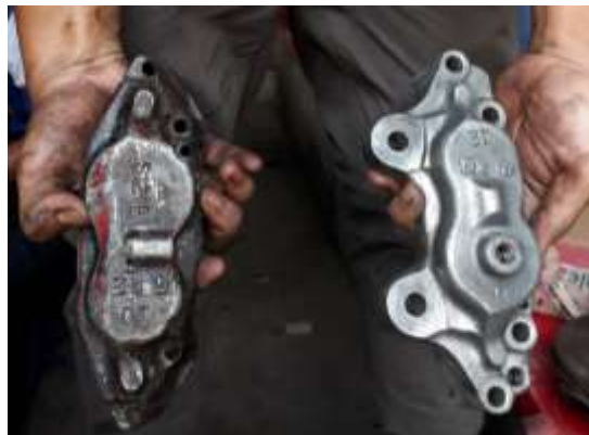
Gambar 3.8 Kondisi caliper rem sebelum dan setelah dibersihkan (Sumber : Dokumentasi pribadi)
