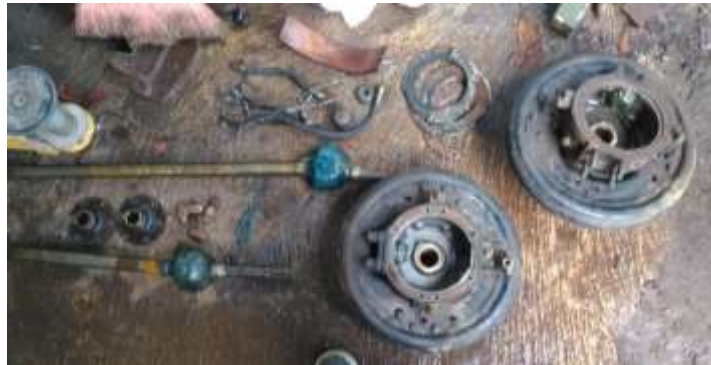
Gambar 3.4 Kondisi rem tromol setelah dibongkar dari unit kendaraan (Sumber : Dokumentasi pribadi)
