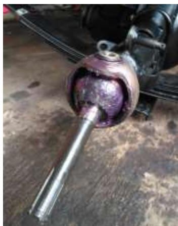
Gambar 3.12 Kondisi drive shaft setelah dipasang kembali ke unit (Sumber : Dokumentasi pribadi)
