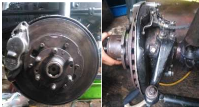
Gambar 3.13 Kondisi rem cakram setelah dipasang kembali ke unit (Sumber : Dokumentasi pribadi)
