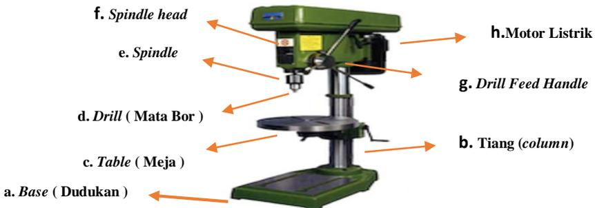
**Gambar 2. 13** Bagian Mesin Bor
